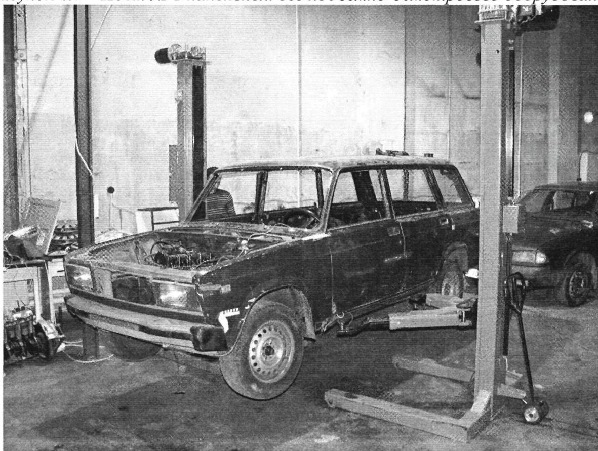
*Рисунок 4.8 – Пост № 2 напольный с подъемно-осмотровым оборудованием*
